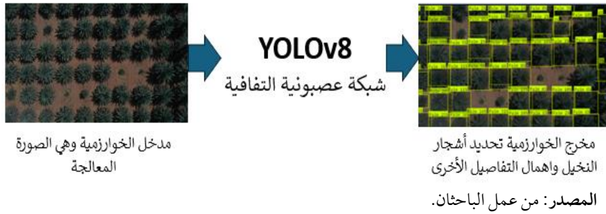
الشكل رقم (٨): مدخلات ومخرجات الشبكة العصبونية التفاضلية YOLOv8.
